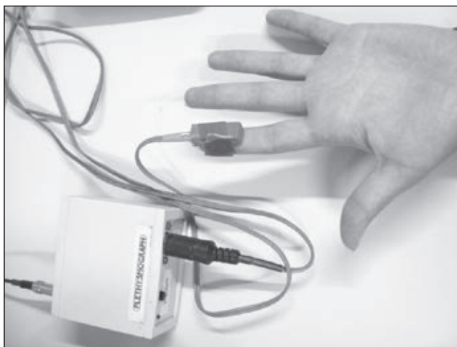
Abb. 12: Plethysmograph und Position der Photodiode am linken Zeigefinger der Versuchsperson
